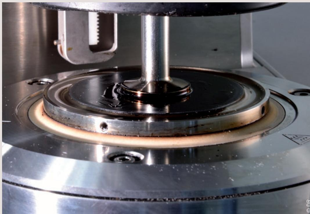
Essai de cisaillement dynamique (DSR) sur bitume au laboratoire BP de Gelsenkirchen, Allemagne.
